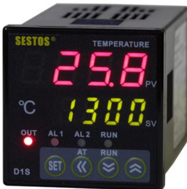
Doppio controller di temperatura con modalità di controllo PID e on/off, display a LED, ampio range di controllo per sonde tipo K (da -50°C a +1300°C) e alimentazione AC/DC 12-24 V.
