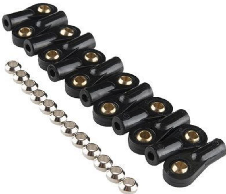
Queste teste a snodo dispongono di un foro (non filettato), dove solitamente vengono inserite delle barre filettate da 4 mm (non incluse), per creare sistemi di leve e bracci per qualsiasi applicazione. Sono dotate di una sfera libera di muoversi e con un foro centrale del diametro di 3,5 mm. La confezione comprende 12 teste a snodo con rondella.
