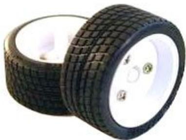
Confezione contenente una coppia di ruote in plastica bianche con pneumatico. Diametro esterno ruota: 56 mm, larghezza del pneumatico 25 mm. La confezione comprende: due hub per l'utilizzo con alberi tondi da 4 mm, due hub per l'utilizzo con alberi esagonali da 3 mm, viti e dadi.
