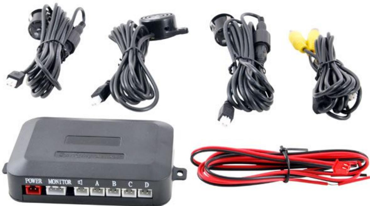
Set composto da due sensori di parcheggio con relativa centralina. È inoltre disponibile un buzzer che segnala, tramite una serie di bip l'avvicinarsi dell'ostacolo, e con un bip continuo quando l'ostacolo si trova ad una distanza di 40 centimetri o inferiore. Il tutto viene alimentato con le luci di retromarcia ed entra pertanto automaticamente in funzione quando si inserisce la retromarcia.
