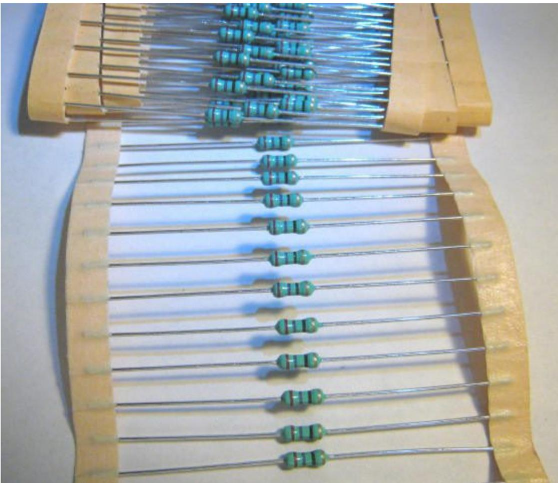
Set 200 resistenze da 27 ohm 1/4 di watt 5% - strato di carbone.
