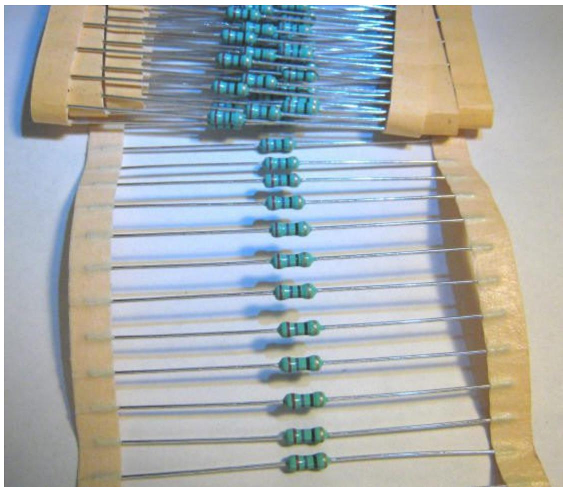
Set 200 resistenze da 33 ohm 1/4 di watt 5% - strato di carbone.
