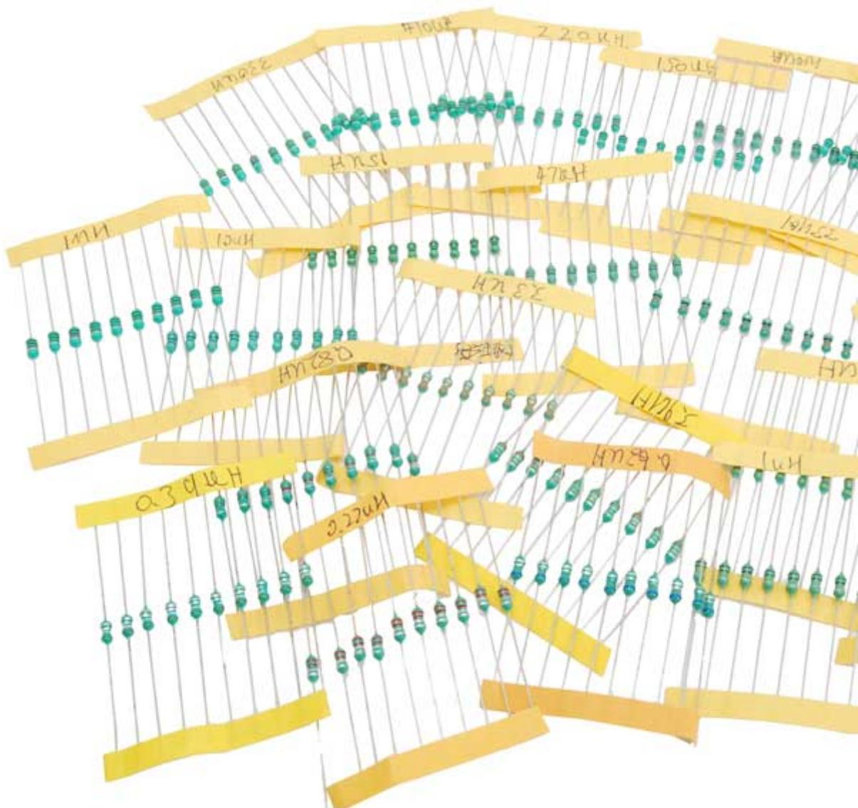
Set composto da 10 induttanze per i seguenti valori: 0,22  $\mu$ H, 0,39  $\mu$ H, 0,47  $\mu$ H, 0,56  $\mu$ H, 0,68  $\mu$ H, 0,82  $\mu$ H, 1  $\mu$ H, 1,5  $\mu$ H, 3,3  $\mu$ H, 3,9  $\mu$ H, 4,7  $\mu$ H, 6,8  $\mu$ H, 10  $\mu$ H, 15  $\mu$ H, 22  $\mu$ H, 33  $\mu$ H, 47  $\mu$ H, 56  $\mu$ H, 100  $\mu$ H, 150  $\mu$ H, 220  $\mu$ H, 330  $\mu$ H, 820  $\mu$ H, 1000  $\mu$ H.
