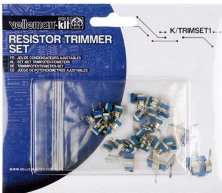
Set contenente 35 trimmer resistivi da 0,1 watt con i seguenti valori: 5 da 470 ohm, 5 da 1 kohm, 5 da 10 kohm, 5 da 47 kohm, 5 da 100 kohm, 5 da 470 kohm, 5 da 1 Mega ohm. Temperatura di lavoro: da -10°C a +70°C, tolleranza resistenza: circa 30%, tensione di lavoro: max. 50 volt, angolo di rotazione: 200°, temperatura di saldatura: 260°C.
