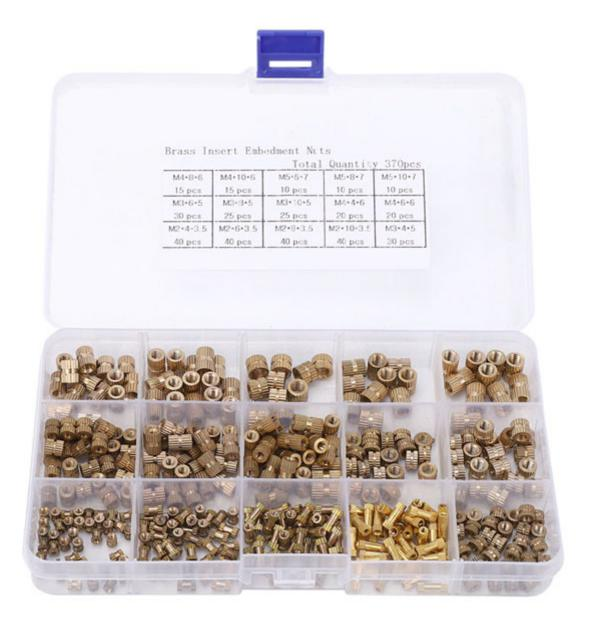
Confezione contenente 370 dadi filettati zigrinati utilizzabili per materiali plastici come PLA, PETG, ABS, ecc. Realizzati in ottone, sono normalmente utilizzati nello stampaggio ad iniezione, ma possono essere utilizzati anche in pezzi stampati in 3D. Per inserirli nei fori stampati in 3D basta scaldarli con un saldatore e spingerli nei fori. La confezione comprende:
