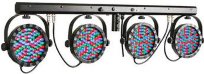
Set composto da 4 proiettori con 75 LED RGB ciascuno, barra di supporto in metallo, stand (altezza max. 210 cm), pedaliera di controllo con cavo da 5 m e custodia per il trasporto. Ogni proiettore può essere orientato separatamente. Funzionamento a controllo musicale (microfono integrato) o con programmi predefiniti. Alimentazione 230 Vac/34 W.
