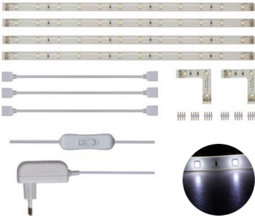
Set composto da 4 strip autoadesivi con 12 LED bianchi (tipo 3528) ad alta luminosità ciascuno dalla lunghezza di 30cm, 2 strip ad angolo con 3 LED, 6 connettori, 3 cavi e 1 alimentatore di rete. Le strip possono essere tagliate a piacimento ogni 3 LED (10 cm) per adattare l'illuminazione alla forma desiderata.
