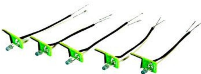
Set composto da 5 indicatori a LED color blu, montati su un piccolo PCB, completi di cavetto e alimentati a 12 Vdc attraverso il modulo pulsanti ad 8 canali per sistemi VELBUS codice 8220-VMB8PB o 8220-VMB8PBU. Utili come segnalatori luminosi per pulsanti della Bticino® della serie Living®, Light® & Light-Tech®. **Attenzione!** non alimentare direttamente a 220 Vac.
