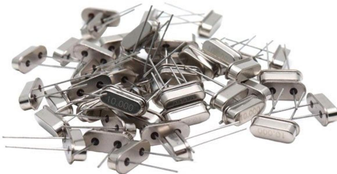
Set composto da 50 quarzi a basso profilo (case HC-49S), 5 pezzi per ognuno dei seguenti valori: 6 MHz, 8 MHz, 10 MHz, 11.0592 MHz, 12 MHz, 16 MHz, 24 MHz, 24.576 MHz, 25 MHz, 40 MHz.
