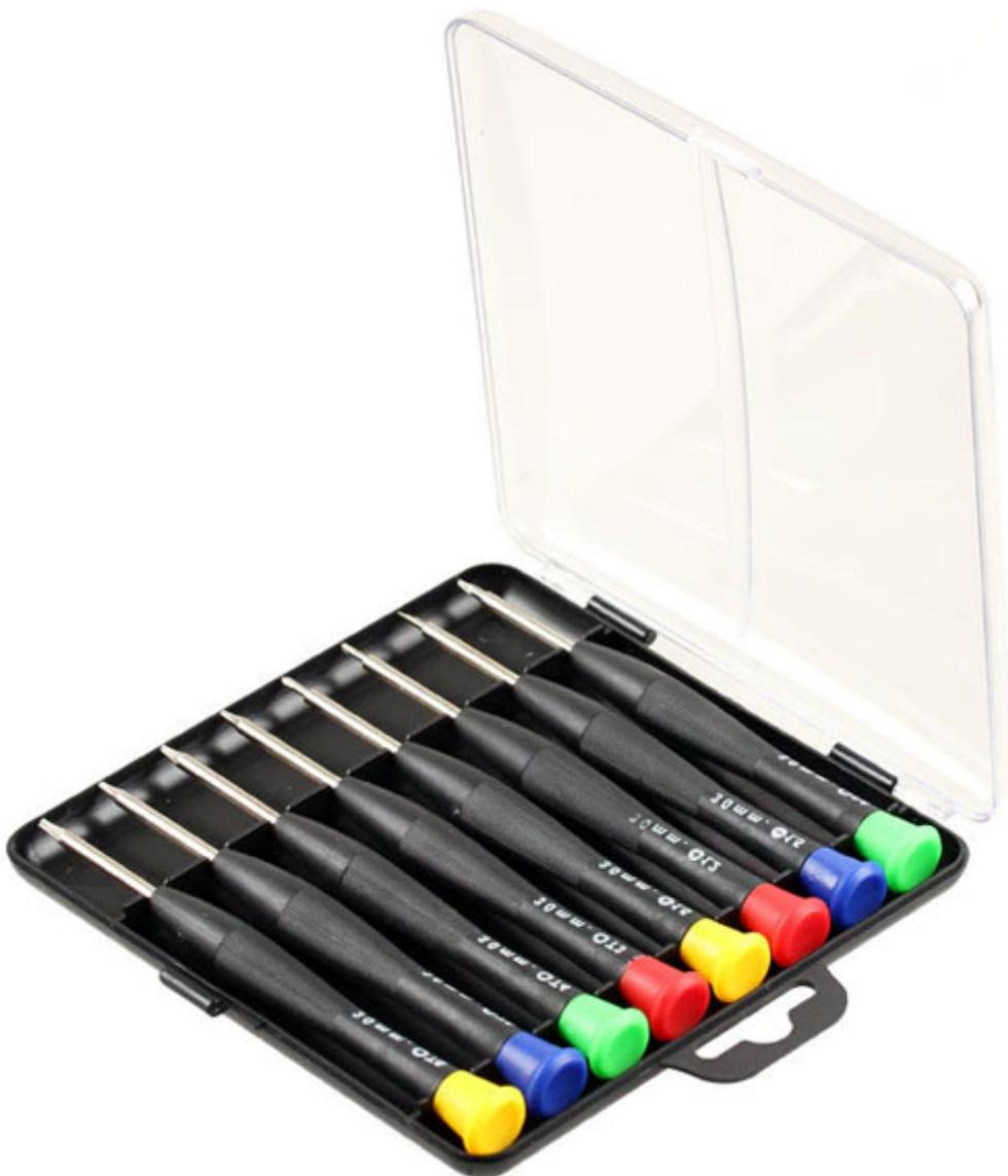
Set composto da 8 giraviti di precisione: cinque con impronta a TORX (T0,8x30 mm, T3x30 mm, T4x30 mm, T5x30 mm, T6x30 mm), due con impronta a croce (1,2x30 mm e 1,5x30 mm) e uno con impronta a taglio (1,5x30 mm). Lunghezza (impugnatura + stelo): 115 mm. Fornita in una pratica custodia in plastica rigida. Ideale per TV, strumenti di comunicazione, strumenti ottici, macchine fotografiche, computer, videoregistratori, telefoni, ecc.
