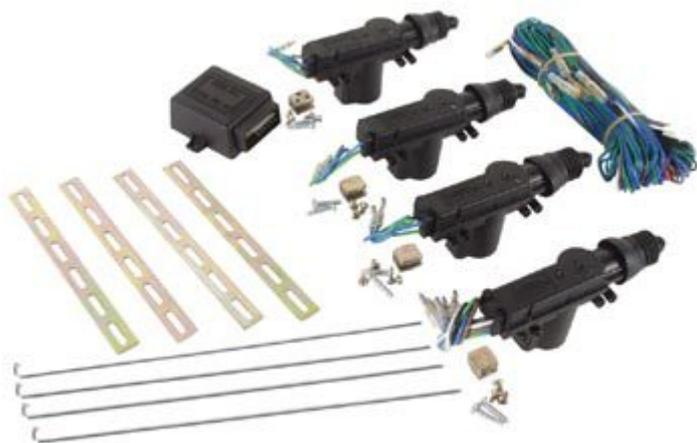
Set per la realizzazione di un impianto di chiusura centralizzata per autoveicoli. Comprende un attuatore elettrico con switch (master), da installare sulla portiera del guidatore, e di tre attuatori slave per le rimanenti portiere. Collegata al ricevitore ( 8220-VM130), può essere gestita a distanza tramite l'apposito trasmettitore ( 8220-VM130T ). Completo di staffe, viti e accessori per il montaggio.
