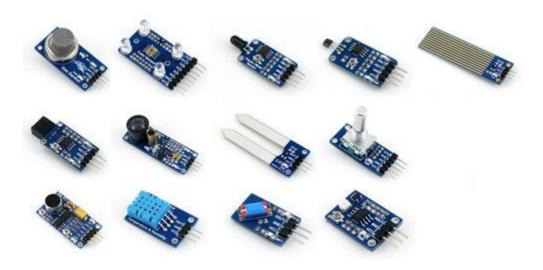
Confezione contenente i seguenti 13 sensori: scheda con sensore gas MQ5, sensore colore, sensore di fiamma, sensore di HALL, sensore ostacoli IR, scheda con LASER meter, sensore umidità terreno, amplificatore microfonico, sensore di temperatura e umidità, sensore di movimento, sensore di raggi UV, sensore livello liquidi, 3 cavetti con connettore 3 pin, 4 cavetti con connettore 4 pin e 1 cavetto con connettore 5 pin. **N.B.** per maggiori dettagli sui sensori vedere i prodotti correlati.
