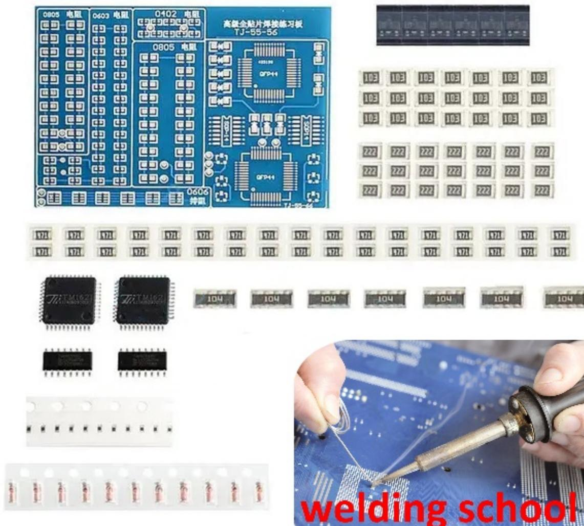
Confezione contenente un PCB e differenti componenti SMD (resistenze, diodi, transistor, chip, ecc) da saldare nelle rispettive piazzole. Utile per chi vuole prendere dimestichezza nella saldatura a stagno di questi piccoli componenti.
