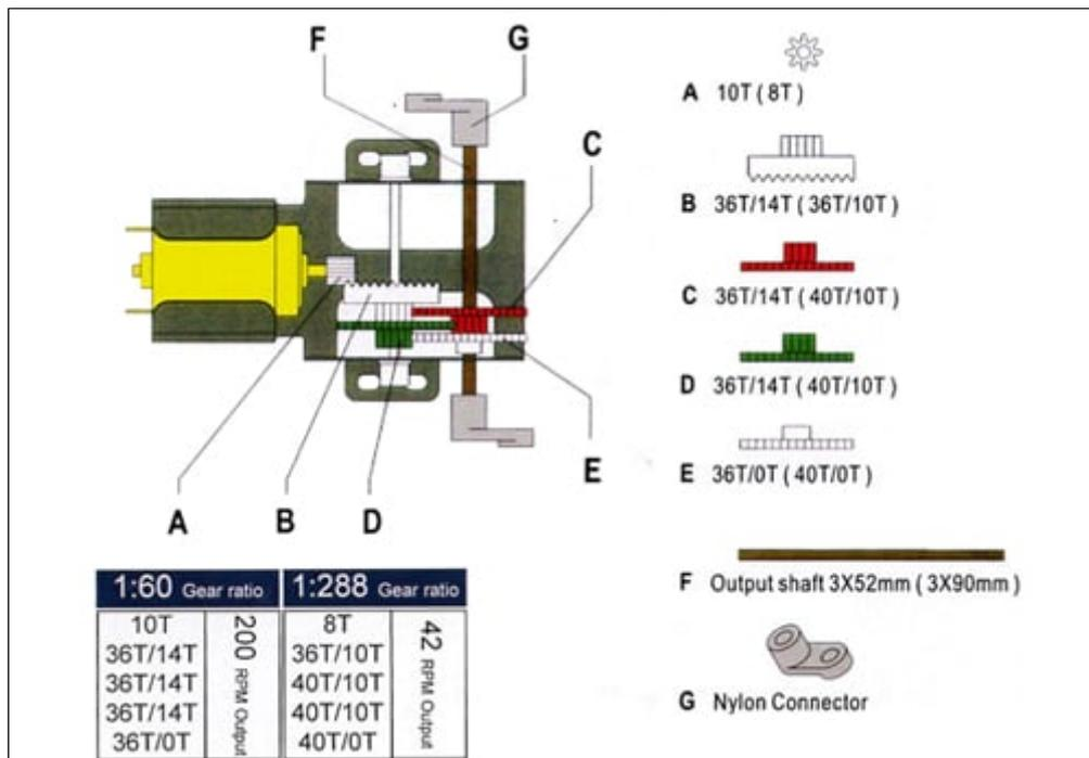
Scatola ingranaggi completa di motore con doppio set di ingranaggi per modificare la velocità dei modelli. Adatta ai modelli motorizzati in legno della serie KNS. La confezione comprende: un motore, un set di ingranaggi, un supporto ingranaggi, due alberi in metallo e altri accessori.
