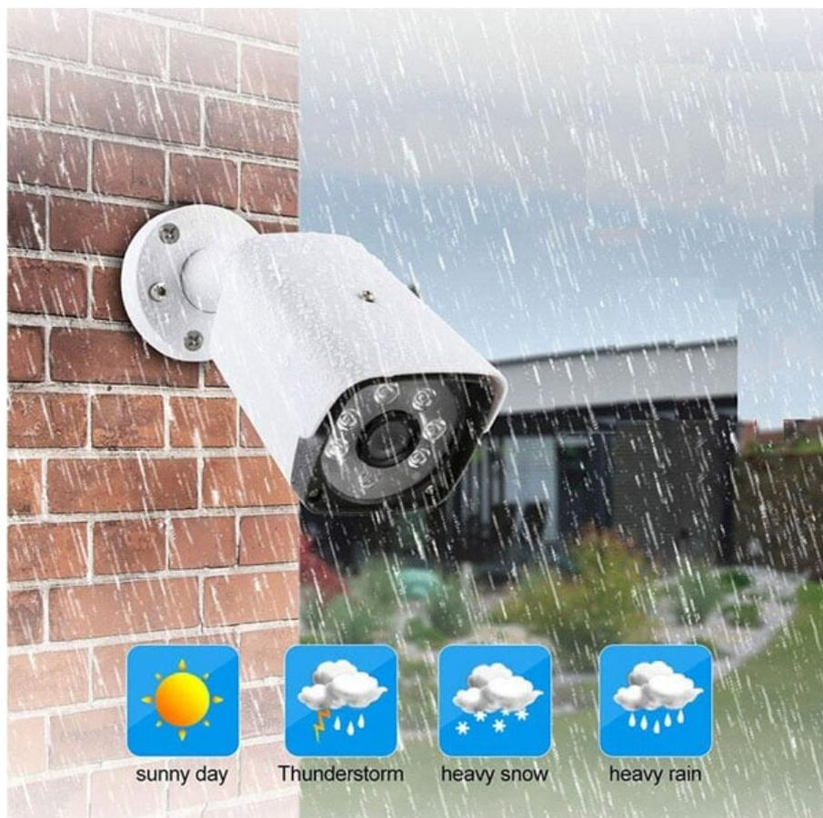
Telecamera bullet a colori waterproof (IP66) da esterno da 5 Megapixel. Dotata di processore e sensore d'immagine CMOS 1/3" XM 330+2003 e obiettivo da 3,6 mm. È dotata di 6 LED all'infrarosso che permettono una visione ottimale anche in condizioni di luce critica. I LED IR si attivano automaticamente al di sotto di una certa soglia luminosa e sono in grado di illuminare fino ad una distanza di 20 metri. La telecamera viene fornita completa di staffa di fissaggio in metallo.
