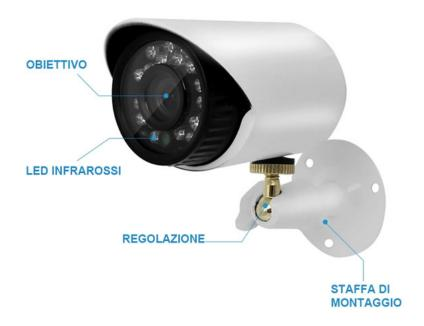
Telecamera bullet a colori waterproof (IP66) da esterno da 2 Megapixel. Dotata di processore e sensore d'immagine CMOS 1/3" XM 330+2003 e obiettivo da 3,6 mm. È dotata di 24 LED all'infrarosso che permettono una visione ottimale anche in condizioni di luce critica. I LED IR si attivano automaticamente al di sotto di una certa soglia luminosa e sono in grado di illuminare fino ad una distanza di 20 metri. La telecamera viene fornita completa di staffa di fissaggio in metallo.
