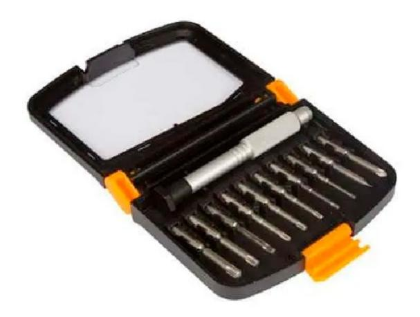
Valigetta contenente un giravite in alluminio e dieci inserti in cromo vanadio. Il giravite è lungo 89 mm, mentre i seguenti inserti: 1 a croce PH1, 1 a taglio SL3.0, 8 a stella T5, T6, T7, T8, T9, T10, T15, T20 (Torx - Tamper Resistant), sono lunghi 25 mm. Dimensioni valigetta (mm): 103x84x20.
