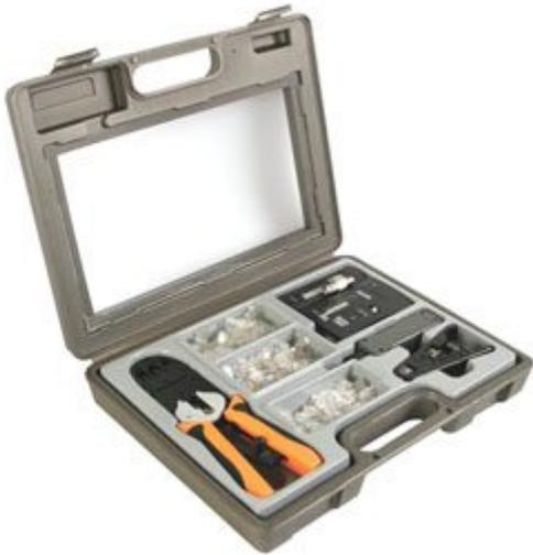
Pratica valigetta in plastica rigida indispensabile per avere sempre a portata di mano l'attrezzatura per il crimpaggio di connettori 8P8C/RJ45, 6P6C/RJ12, 6P4C/RJ11, 4P4C. La valigetta comprende anche un tester per reti LAN, inseritore per connettori IDC con lame tipo 100/88 e 66, attrezzo per tagliare e sguainare cavi UTP/STP e 125 connettori modulari: 50 x 6P6C, 50 x 4P4C, 25 x 8P8C. **N.B.** la batteria da 9V per il tester LAN non è compresa.
