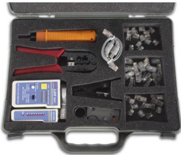
Praticissima valigetta in plastica rigida indispensabile per avere sempre a portata di mano l'attrezzatura per il crimpaggio di connettori modulari RJ11, RJ12 e RJ45. Il set contiene, anche, 45 connettori in tre formati differenti (6P6C/6P4C/8P8C, 15 per formato) e un tester per reti LAN.
