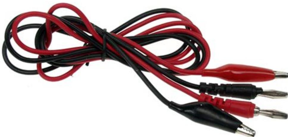
Set composto da 2 cavetti (rosso e nero) lunghi 90 cm con plug a banana da 4 mm da un capo e coccodrillo dall'altro. Massima tensione e corrente che può attraversare il cavo: 30V 2A, diametro esterno del cavo 2,8 mm, sezione del filo 16x0,1 mm.
