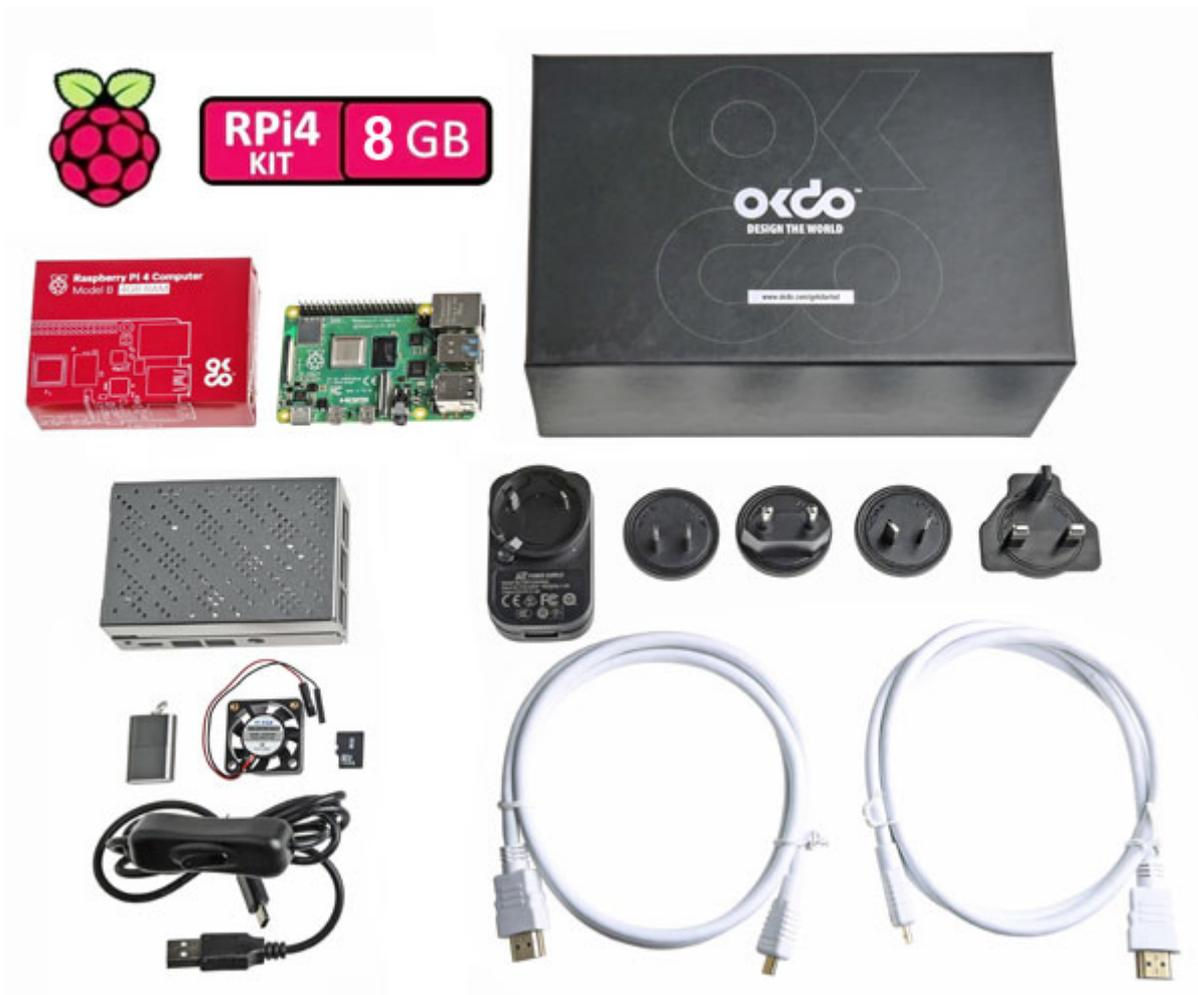
Set Raspberry Pi 4 comprensivo di scheda Raspberry Pi 4 da 8 GB e da tutto il necessario per iniziare a lavorare con questo minicomputer. Il set contiene un Raspberry Pi 4 con memoria da **8 GB**, un alimentatore da rete con adattatori internazionali, 2 cavi micro HDMI/HDMI, MicroSD da 32 GB con NOOBS 3.1.1 precaricato, lettore di schede SD, dissipatori di calore e contenitore metallico con ventola integrata. **CONTENUTO DEL BOX:**
