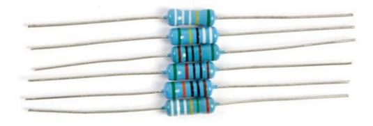
Set composto da 6 resistenze di precisione per il voltmetro digitale LCD da incasso a 3 1/2 cifre (PMLCDL) e il voltmetro digitale a LED rossi da pannello a 3 1/2 cifre (PMLED5). Consentono di impostare la portata del voltmetro.
