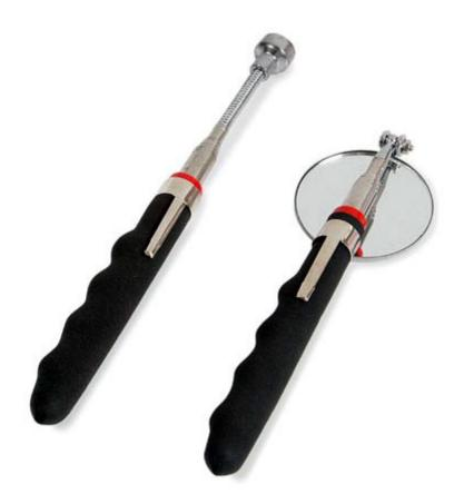
Set composto da uno strumento di prelievo con testa magnetica e da uno specchio di ispezione. Lo strumento di prelievo, indicato per raccogliere rondelle, viti, dadi o bulloni, ecc; dispone di asta estensibile e manico con impugnatura ergonomica. La lunghezza totale (manico compreso) con asta completamente chiusa è di 200 mm, mentre con l'asta completamente estesa è di 660 mm.
