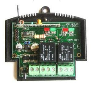
Sistema di controllo via radio a due canali composto da un compatto trasmettitore radio con codifica a 32 bit da un ricevitore ad autoapprendimento a due canali completo di contenitore. Al sistema è possibile abbinare altri trasmettitori (cod. 8220-VM130T). I dispositivi sono forniti già montati e collaudati. Lo spezzone di filo presente all'interno del ricevitore che funge da antenna garantisce una portata di circa 30 metri.
