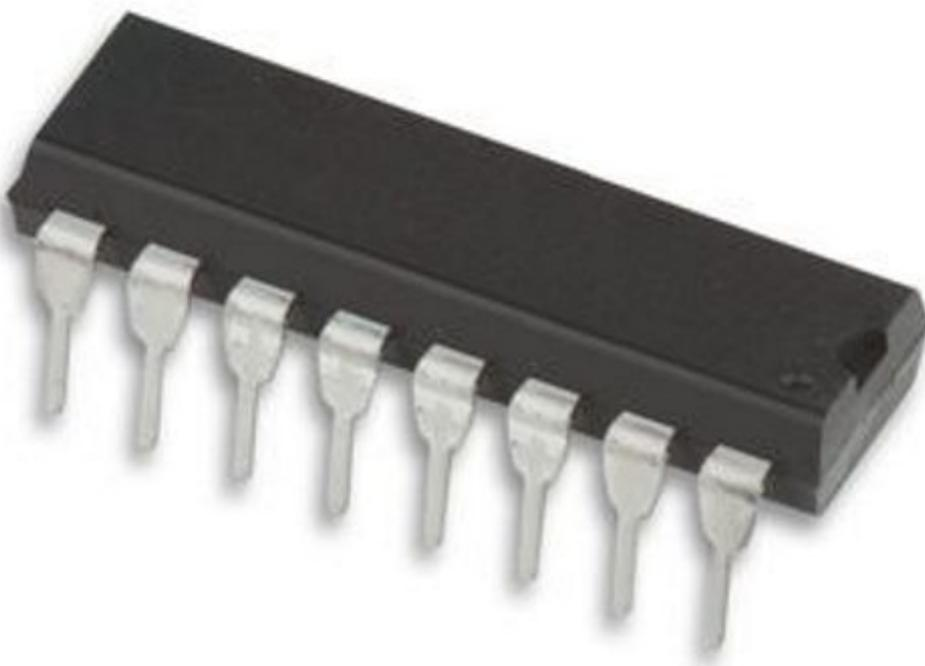
SG3525 PILOTA PWM Tipologia: Half Bridge, Push-Pull Numero di uscite: 2 Output Frequenza di commutazione: 400 kHz Ciclo utile - Max: 49 % Tensione di ingresso: 8 V to 35 V Tensione di uscita: 19 V Corrente di uscita: 400 mA Temperatura di lavoro minima: 0 C Temperatura di lavoro massima: + 70 C Stile di montaggio: Through Hole Package/involucro: PDIP-16 Tempo di caduta: 50 ns Tipo di prodotto: Switching Controllers Tempo di salita: 100 ns
