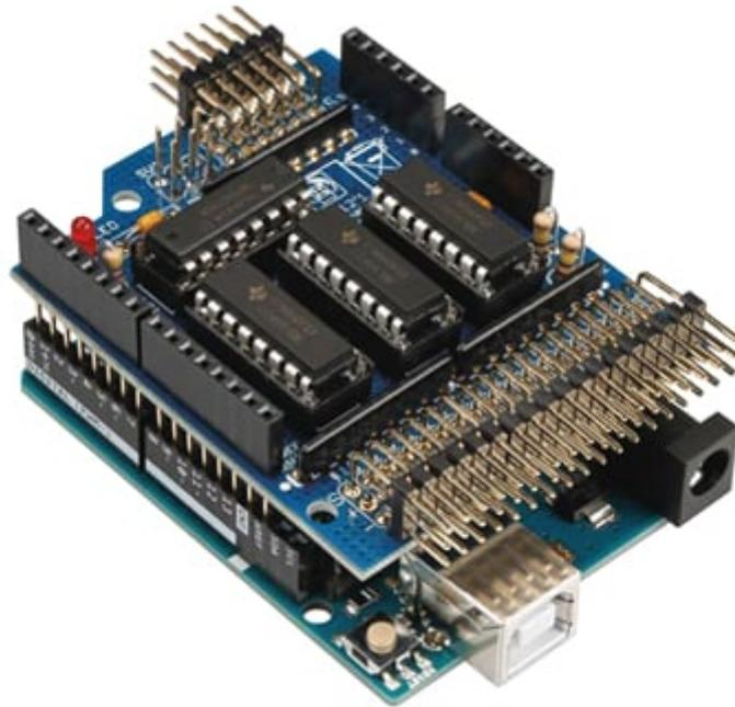
Shield per Arduino Uno che consente, utilizzando 4 pin I/O (3 digitali e 1 analogico), di aggiungere 24 ingressi analogici (0-5 Vdc). In questo modo saranno disponibili in totale 29 ingressi analogici da utilizzare con sensori o altro. È disponibile la libreria con alcuni esempi. Dimensioni (mm): 66x54.
