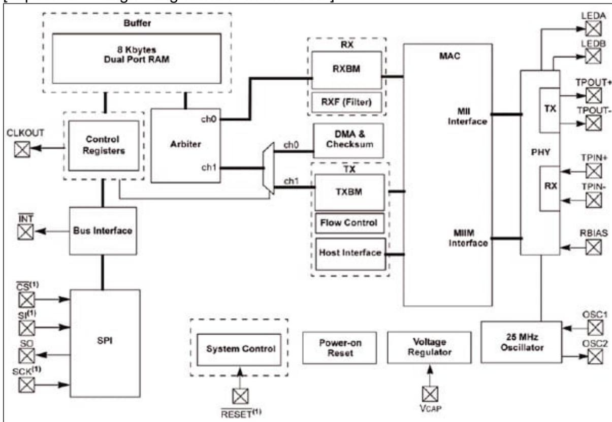
Il componente che realizza l'interfacciamento sull'ethernet per la nostra shield è composto sostanzialmente da un controllore MAC interfacciato tramite bus SPI.[/caption]
