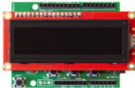
LCD shield con display DISPLAYTECH162B (alfanumerico 16x2)
