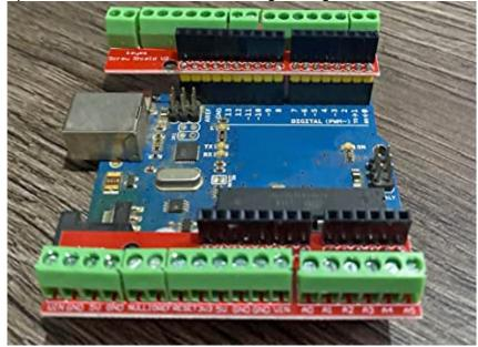
Lo shield montato su una scheda Arduino ( la scheda va acquistata separatamente )[/caption]
