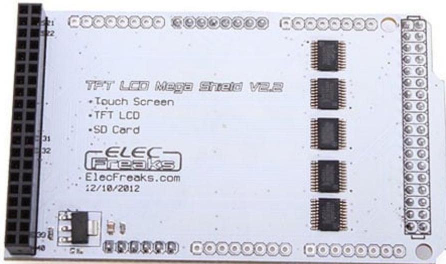
Dotato di 5 integrati 74HC541 (octal buffers and line drivers), questo shield è stato appositamente realizzato per utilizzare il display touchscreen da 3,2", funzionante con livelli di tensione di 3,3 V, con la scheda Arduino Mega. Dimensioni (mm): 90 x 53,30.
