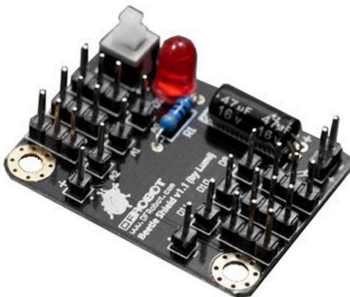
Shield progettato per collegare sensori o servi RC al modulo Beetle (DFR0282). Lo shield rende facilmente accessibili i 6 pin del modulo Beetle (D9, D10, D11 e A0, A1, A2), dispone di due pin di alimentazione (+ e -), un LED e un'interruttore a pulsante per l'alimentazione. Una volta saldato il modulo Beetle, basta fornire l'alimentazione (da 3 V a 5 V) e premere il pulsante a interruttore.
