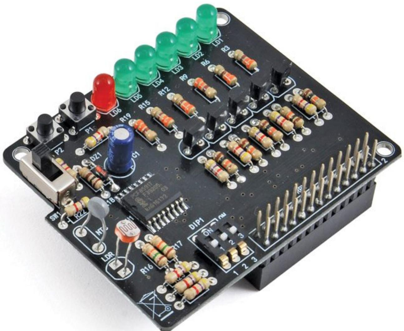
La Scheda di Sperimentazione Analogico/Digitale FT1060 è stata appositamente progettata per sfruttare al massimo il tuo Raspberry Pi. Grazie all'integrato convertitore AD/DA a 8 bit PCF8591, potrai acquisire segnali analogici e digitali con estrema precisione e affidabilità.
