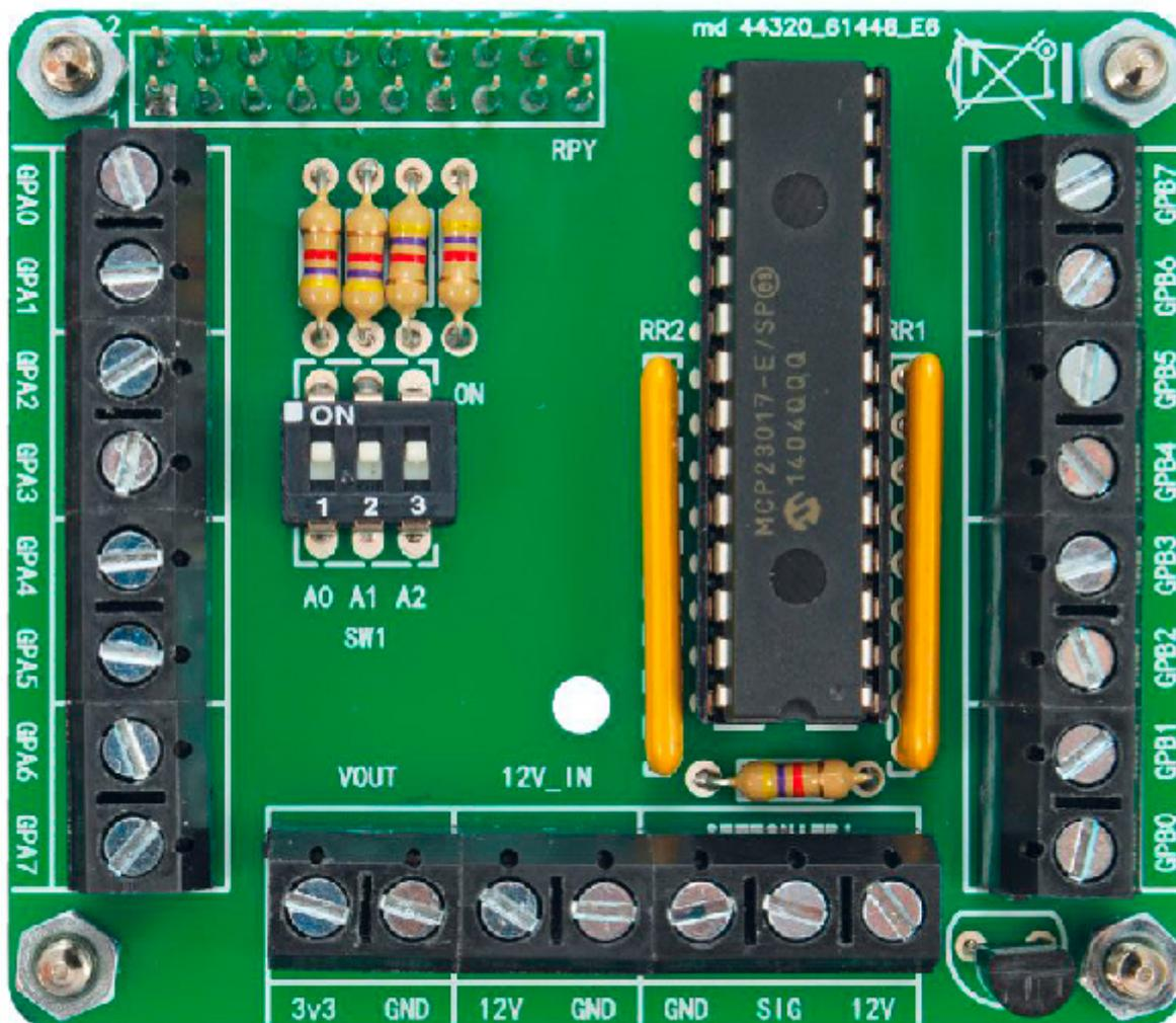
Basato sul chip MCP23017, questo shield permette il collegamento di pad o joystick Arcade e un massimo di 12 pulsanti direttamente a una scheda Raspberry Pi. Lo shield comunica con Raspberry tramite I2C inviando lo stato dei contatti dei pulsanti e del joystick. Lo shield viene venduto in kit da saldare.
