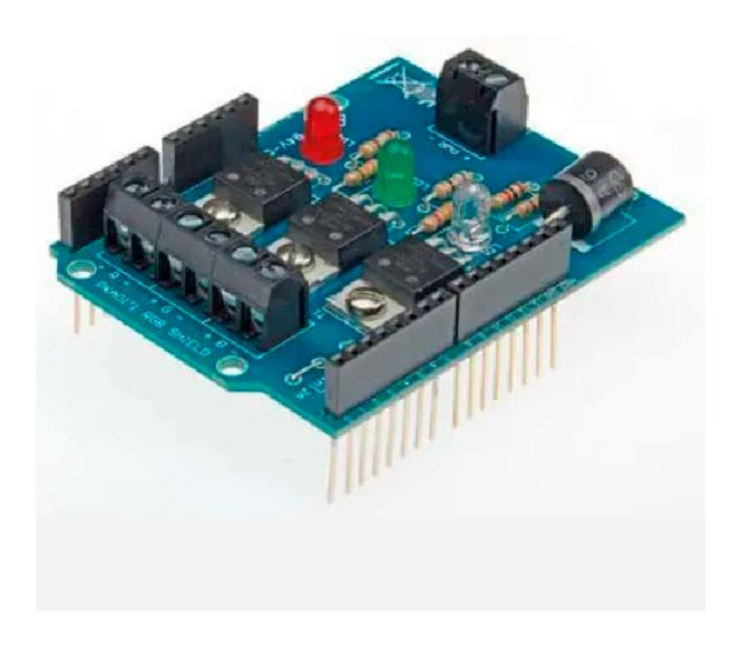
Shield per Arduino che permette di pilotare LED o strip luminosi a LED RGB. Ideale per creare stupendi effetti luminosi. Regolazione PWM del livello d'uscita per ciascun canale. Alimentazione: da Arduino 12 V / 2A max. - tramite morsetto PWR (50 V / 6A max). Dimensioni (mm): 68 x 53. N.B. può essere impilato con altri shield.
