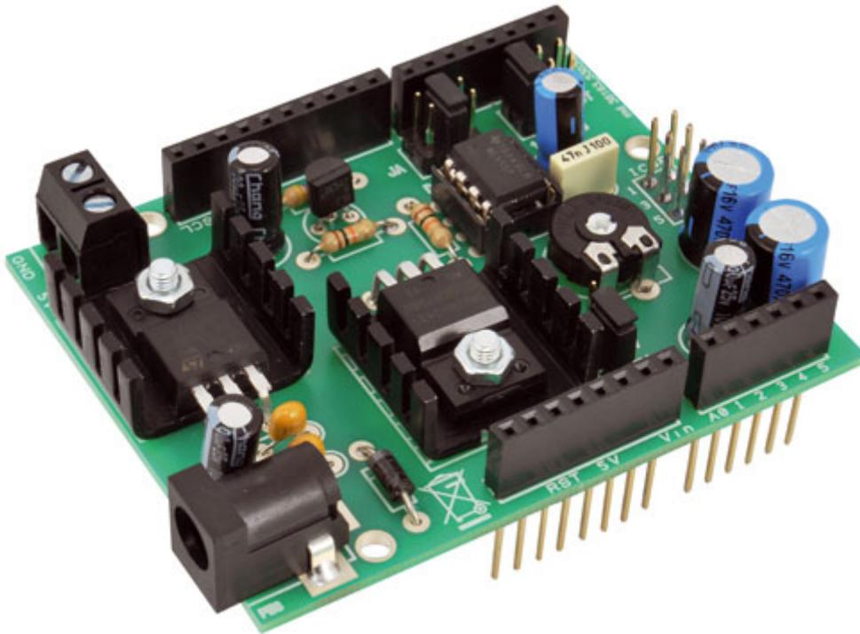
Shield basato sul timer 555 configurato come monostabile in grado di accendere e spegnere Arduino in base ad intervalli regolabili. Sono disponibili tre diverse tempistiche selezionabili tramite jumper: 60 secondi / 10 minuti / 1 ora. Un trimmer permette di regolare finemente queste tempistiche. Lo shield dispone di un ingresso di alimentazione in grado di accettare tensioni comprese tra 7 e 15 volt ed un ingresso per 5 V.
