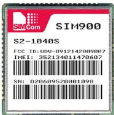
Il SIM900 è un modulo GSM/GPRS quadriband (850/900/1800/1900 MHz) con integrato un potente processore AMR926EJ-S. Integra uno stack TCP/IP e viene controllato tramite comandi AT. Le sue ridottissime dimensioni (24 x 24 x 3 mm), permettono di sviluppare dispositivi molto compatti come localizzatori, combinatori telefonici GSM, telecontrolli, teleallarmi, ecc. Il modulo è a montaggio superficiale (SMT), quindi non richiede alcun connettore.
