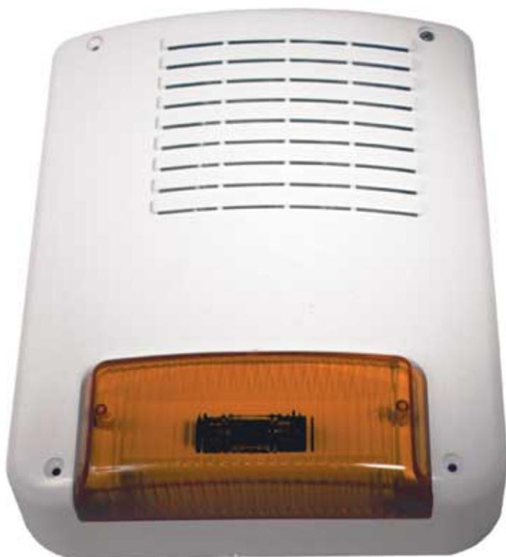
Sirena elettronica, con contenitore in policarbonato autoestinguente, adatta per essere impiegata in ambienti esterni. Blindatura interna in acciaio zincato, lampeggiatore ad alta resa, tamper, pressione sonora 128dB (a un metro), assorbimento medio in allarme 2,5A, assorbimento a riposo 5mA, peso 3kg, vano per batteria da 12V/2Ah (non compresa), dimensioni 295x200x100mm.
