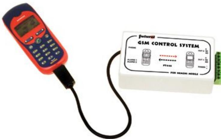
Sistema GSM di controllo remoto bidirezionale realizzato con un cellulare Siemens della famiglia 35 (escluso A35). Consente l
