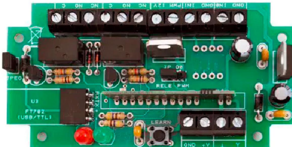
L'FT1083K è una scheda che permette di utilizzare rapidamente i moduli RFTide come unità Slave, ma può fungere anche da Master; essa contiene un modulo RFTide a 5V, uno stadio di alimentazione, due ingressi digitali GPIN0 e GPIN1 in logica positiva (il contatto di chiusura è connesso tra l'ingresso e +5V), due uscite digitali di tipo ON/OFF a relé ed il pin GPOUT0 che può essere configurato come uscita PWM. Dispone inoltre di un pulsante che può essere usato per la
