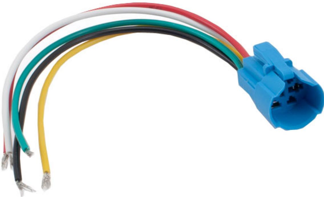
Socket per pulsanti, deviatori, interruttori antivandalo con illuminazione a LED, foro di fissaggio Ø 16 mm e 5 contatti (vedere prodotti correlati). Basta inserire direttamente al suo interno il pulsante antivandalo (deviatore o interruttore) e utilizzare i cavi per il collegamento. Lunghezza dei cavi: circa 13 cm.
