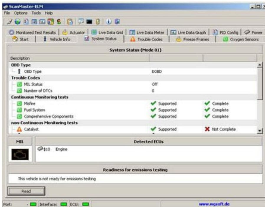
**Sonda Lambda:** risultati test sonda lambda.
