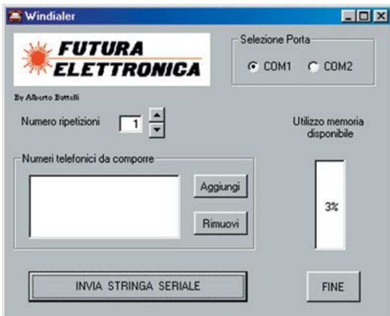
Software per la programmazione dei numeri telefonici nel combinatore FT290K.
