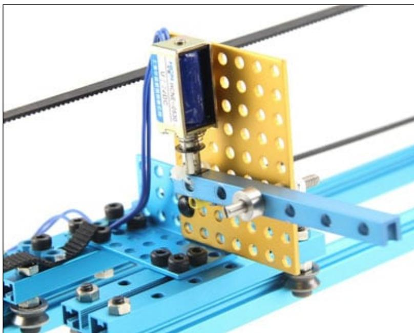
Solenioide a trazione lineare con corsa di 6 mm, alimentazione: 12 Vdc, resistenza: 27 ohm, forza di trazione: 50 grammi. Può essere utilizzato ad esempio per tirare i fili di una piccola mano robotica, come attuttore di un pennino in un plotter, ecc.
