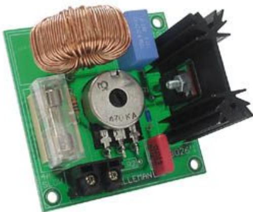
Caratterizzato da piccole dimensioni, questo semplice dimmer può rimpiazzare un interruttore esistente, permettendo di regolare la luminosità di una lampada o di un gruppo di lampade. Questo circuito può essere anche utilizzato per variare la velocità di motori con spazzole a carbone. Completo di soppressore di disturbi.
