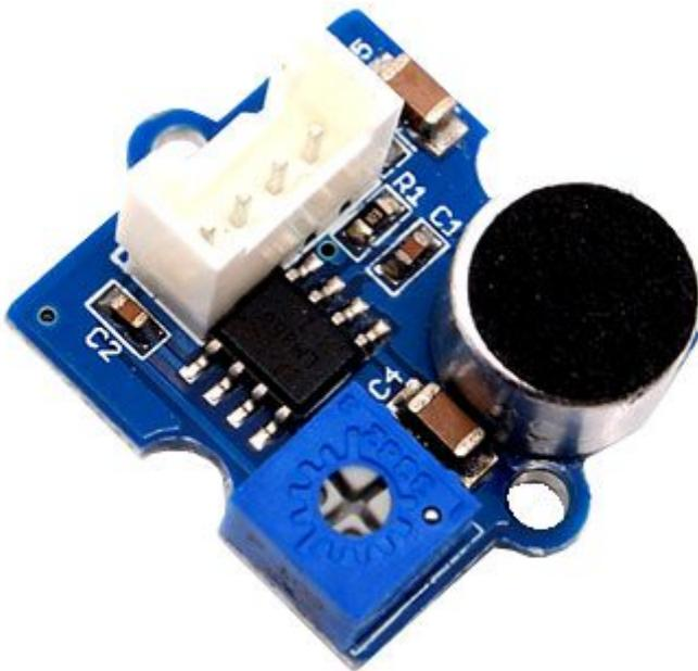
Compatto modulo Grove basato sull'integrato amplificatore LM386 e microfono elettretico. Può essere impiegato come interruttore attivato dal suono, per essere inserito in un robot che si muove a ritmo di musica, ecc. Il valore di uscita può essere regolato tramite l'apposito trimmer. Alimentazione: da 4 Vdc a 12 Vdc
