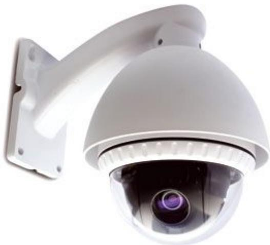
Mini Speed Dome da interno con sensore SONY CCD Interline Transfer da 1/4" a colori. Dispone di una risoluzione di 500 linee TV, Zoom ottico 10X e digitale 10X, sensibilità 0,7 Lux, funzione Day & Night, Pan e Tilt con 360° di rotazione orizzontale e 180° di inclinazione verticale, menu OSD, 127 preset (posizioni prestabilite) impostabili, controllo PTZ, Privacy Zone (4 zone), protocollo di comunicazione: Pelco-D, Pelco-P (selezionabile). Alimentazione 12 Vdc (adattatore di rete incluso).
